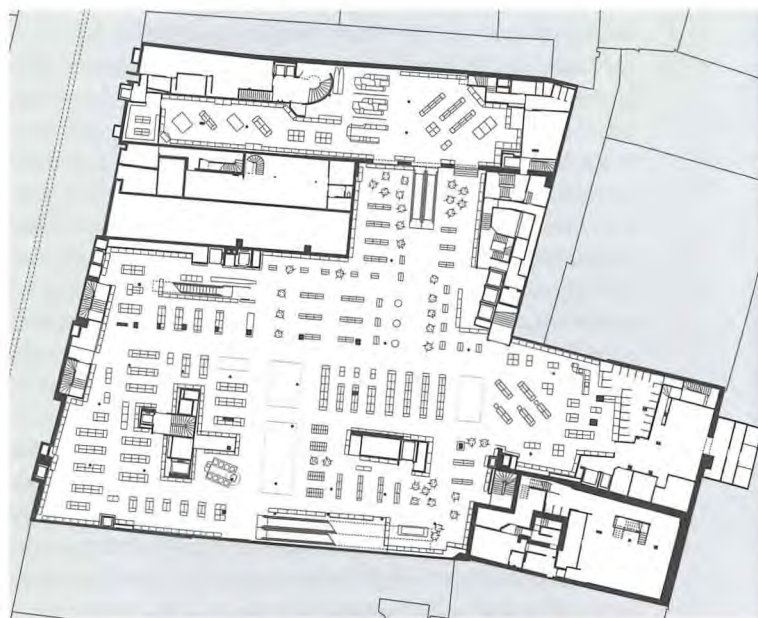
Untergeschoss heute: Supermarkt mit Blinddarm im Nachbarhaus.
